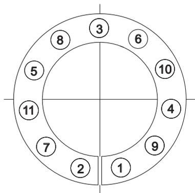
En caso de reutilización del TEK-451 comprobar que la posición de las roscas de extracción del cono anterior, brida intermedia y cono posterior estén colocadas como era inicialmente. En los gráficos siguientes se ejemplifica como debe ir y como no debe ir.
